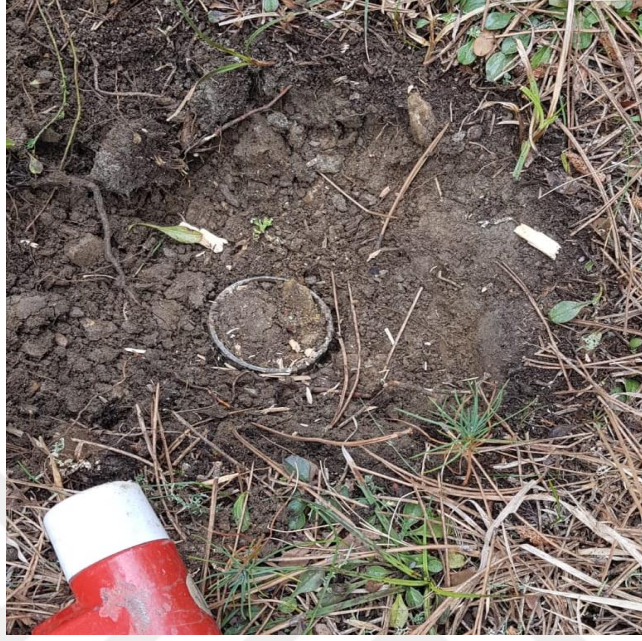
Şekil 3.4 Bozulmamış toprak örneklerinin alınması
