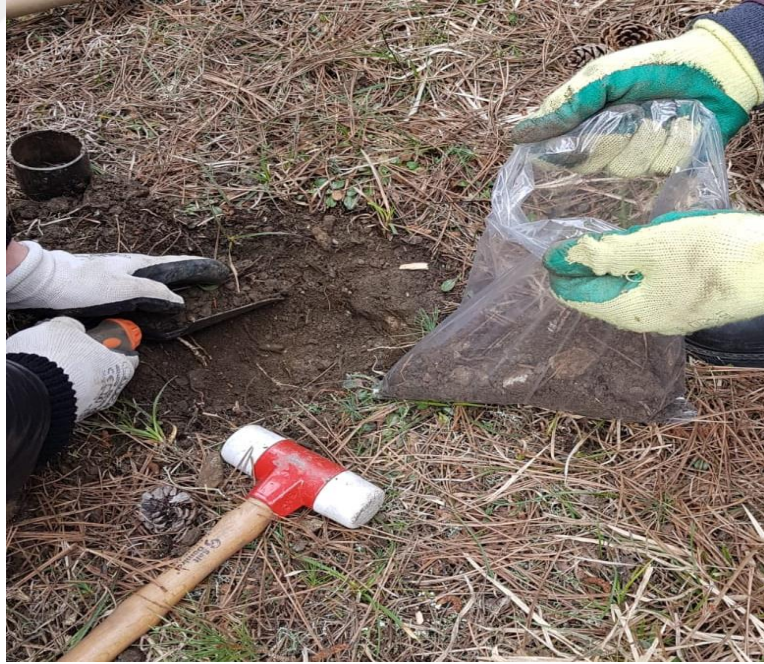
Şekil 3.3 Bozulmuş toprak örneklerinin alınması
