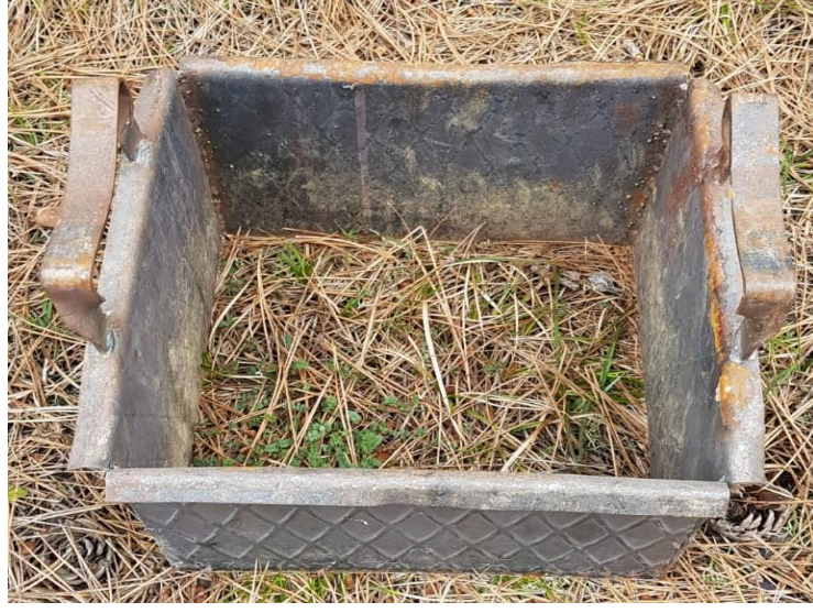
Şekil 3.2 Ölü örtü örneklerinin alınması
