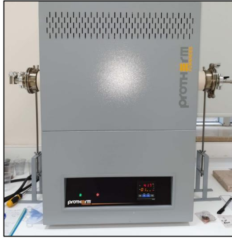
Şekil 4.6 Sinterleme işleminde kullanılan tüp fırın
