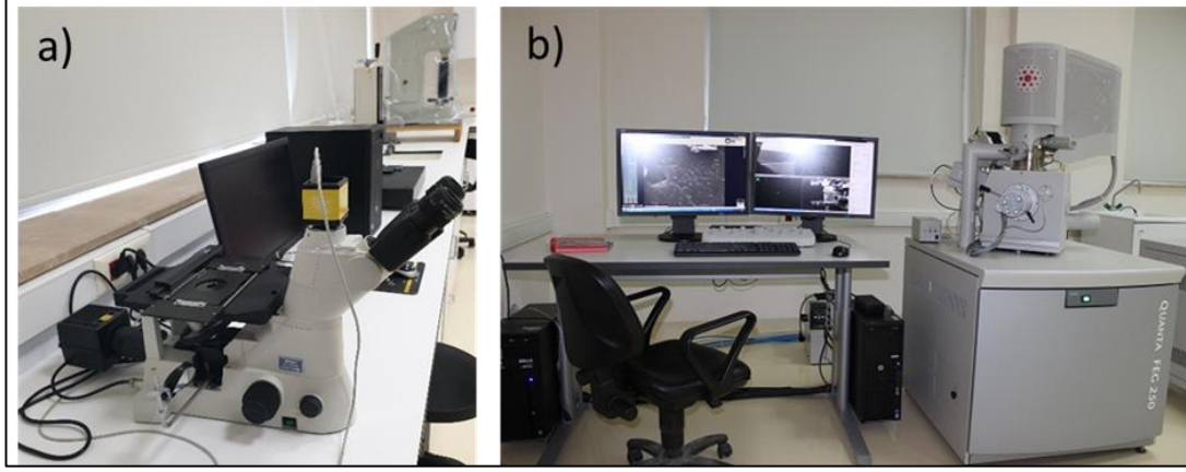
Şekil 4.7 Çalışmada kullanılan optik mikroskop (a) ve taramalı elektron mikroskop (b)
