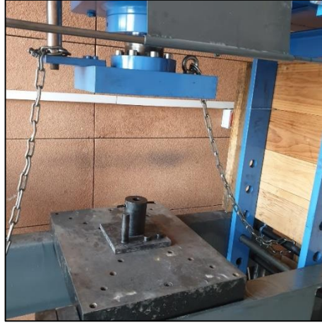
Şekil 4.5 Tozların sıkıştırılmasında kullanılan hidrolik pres
