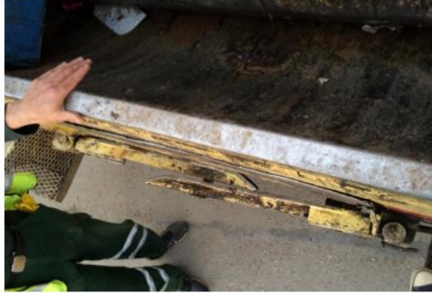
Şekil 8.7. KAİ'nin çöp toplama aracındaki sıkıştırma mekanizmasındaki güvensiz davranışı
