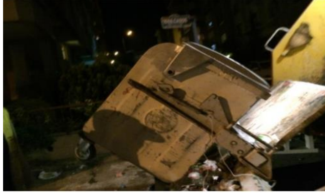
Şekil 8.8. Katı atık boşaltımı esnasında konteyner kapağının açılmaması
