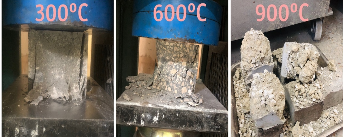
Şekil 3.9. Yangın dayanımı sonrası numune kırımı
