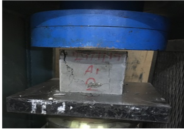
Şekil 3.8. Basınç testi altındaki beton küp
