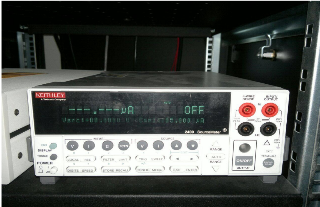
Şekil 5.12. Keitley 2400 akım kaynağı
