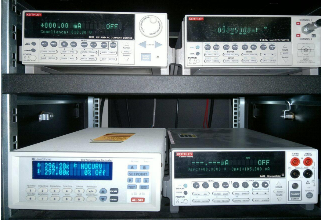
Şekil 5.11. Elektriksel ölçümlerde kullanılan akım ve gerilim kaynakları
