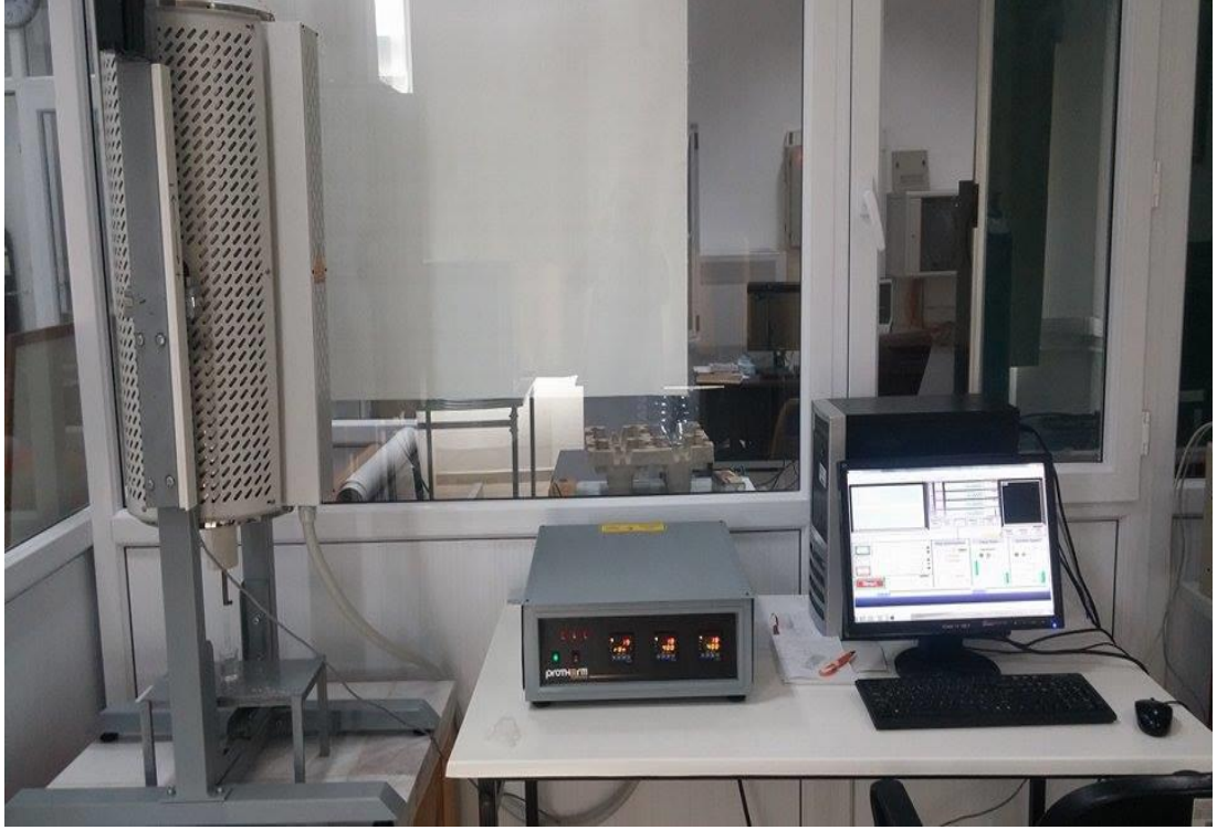
Şekil 4.2. Nano ince filmler için daldırmalı kaplama sistemi
