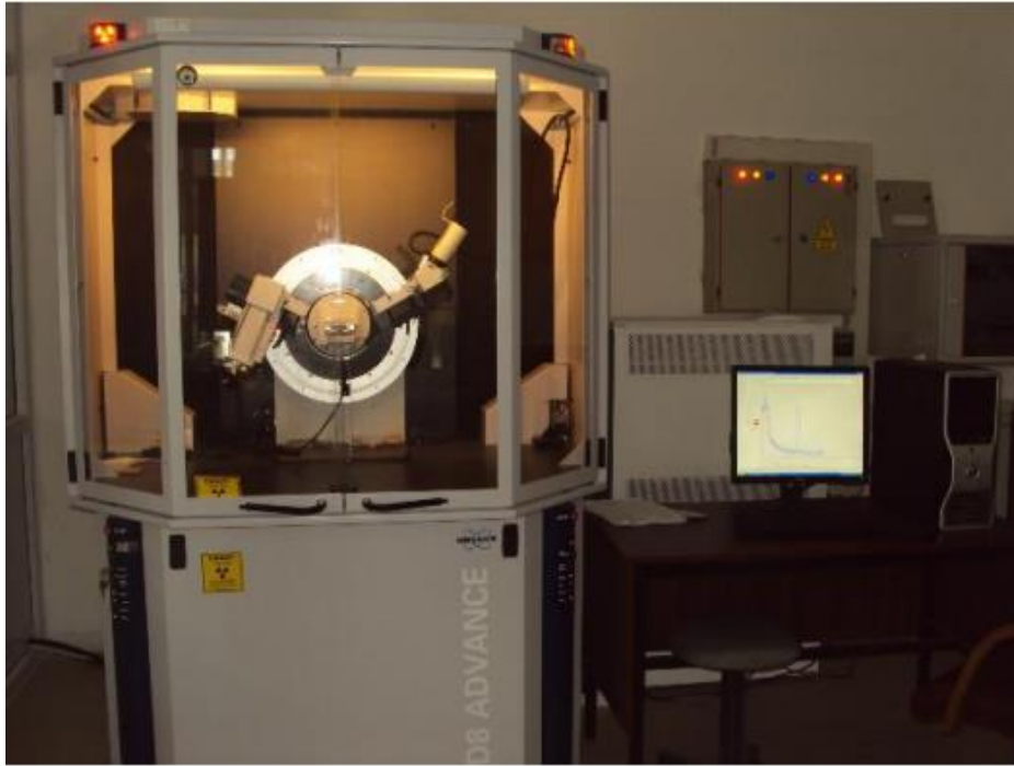
Şekil 3.1. BRUKER D8 ADVANCE model difraktometre
