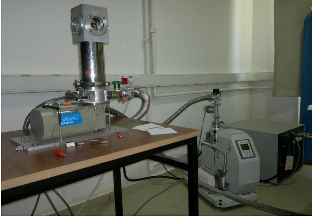
Şekil 5.10. Kapalı devre kriyostat sistemi
