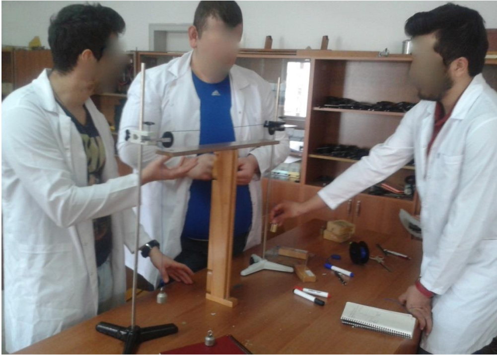
Fotoğraf 3.5. Yatayda kuvvet konusuna ilişkin öğrencilerin hazırlamış oldukları deney düzeneği
