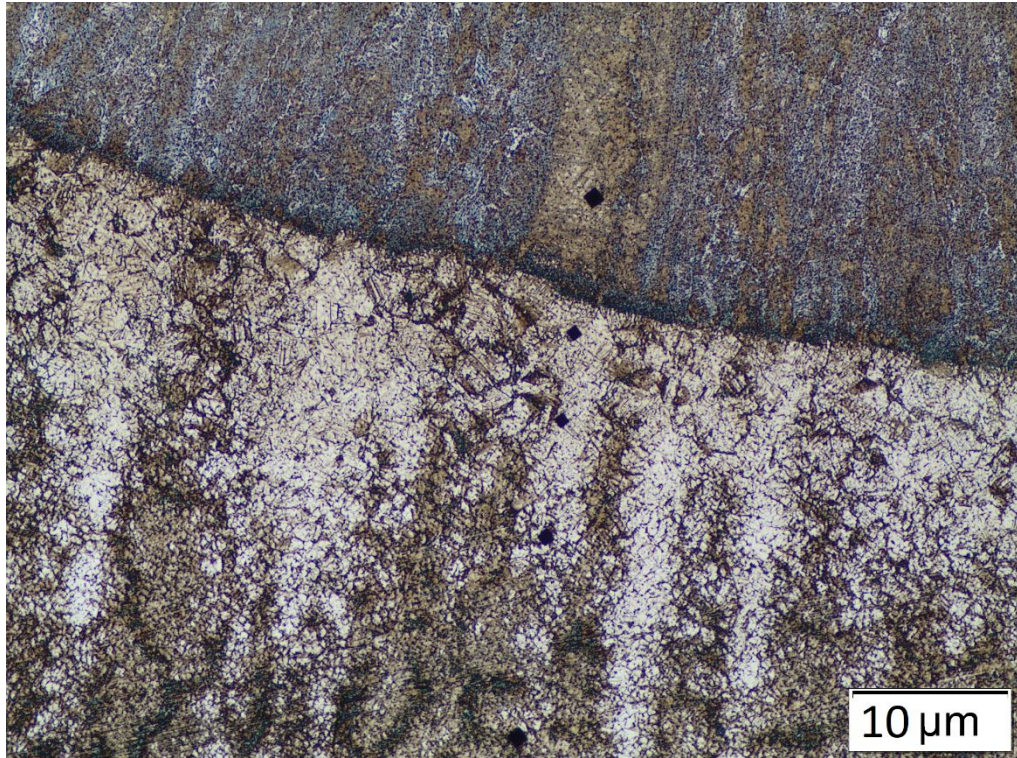
Şekil 6.14. 4 mm'lik parçaların 25 °C de ön tavlama etkisi kaynak sonrası sertlik fotoğrafları
