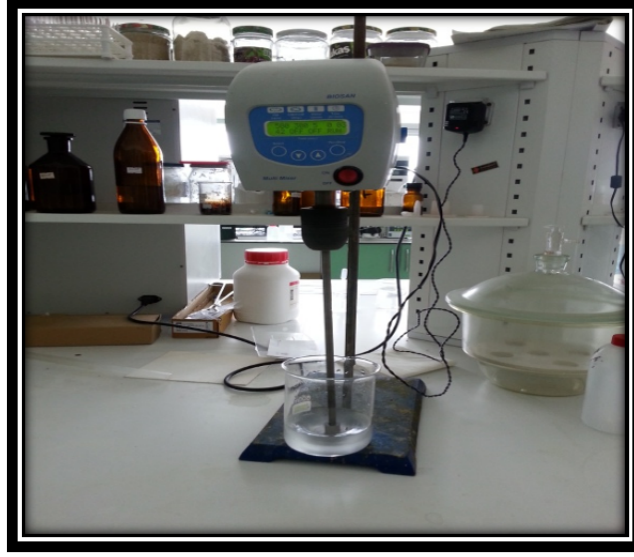
Fotoğraf 3.8. Laboratuvar mikserinde liflerine ayrışması
