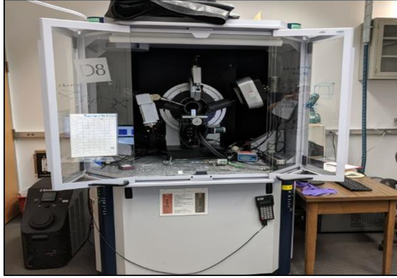
Şekil 4.8 Faz analizi tespiti için kullanılan XRD cihazları
