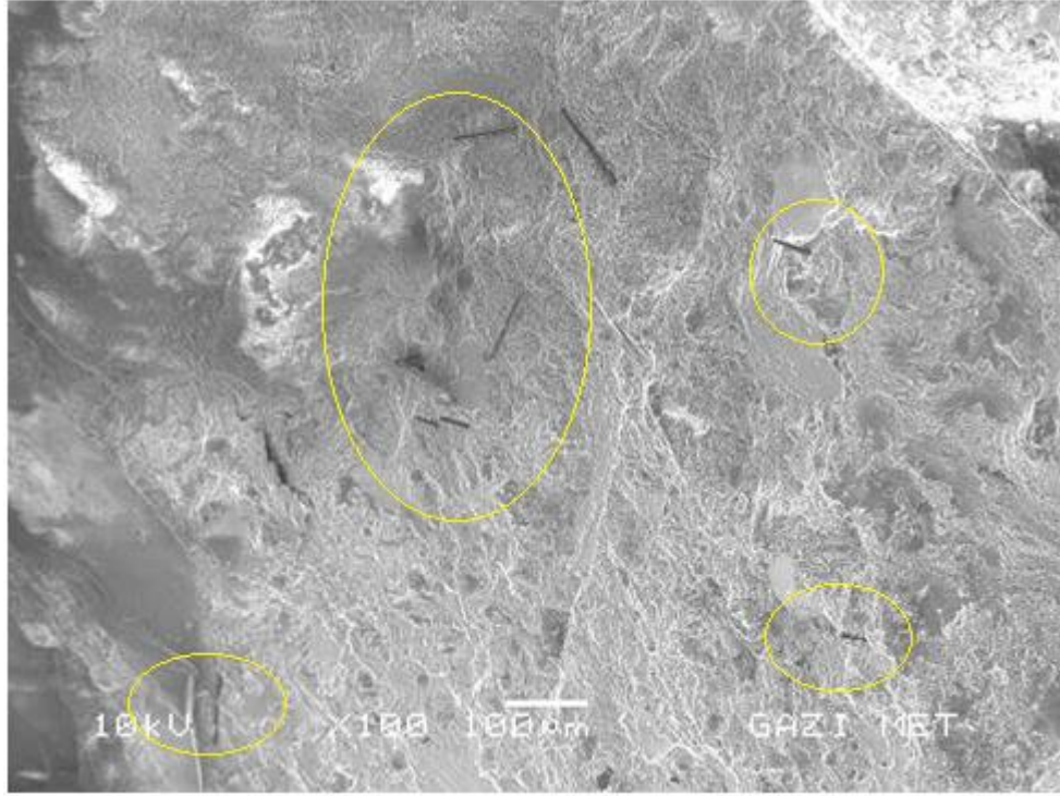
Şekil 4.11 C10+CF%0,5 10mm numunesinin SEM bulguları
