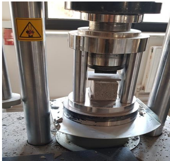
Şekil 3.15 Basınç dayanımı deney uygulaması
