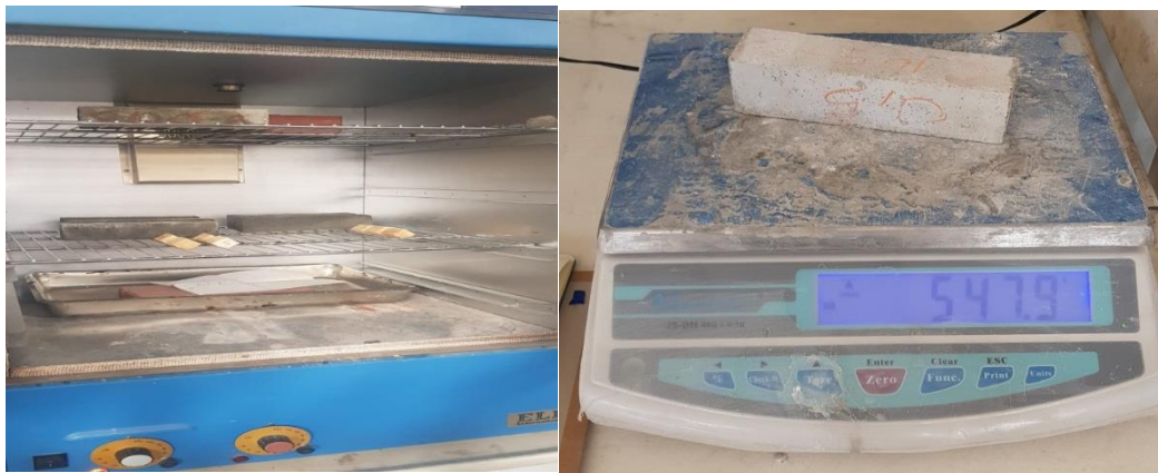
Şekil 3.11 Etüvde bekletilen ve tartımı yapılan numune örneği
