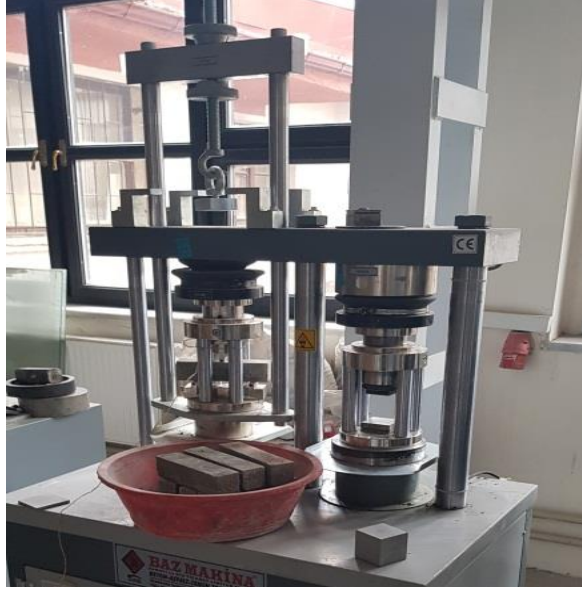
Şekil 3.14 Eğilmede çekme dayanımı deney uygulaması
