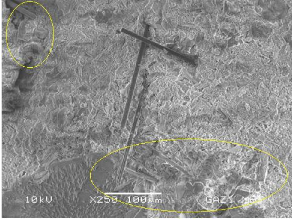
Şekil 4.10 F20+CF%1 10mm numunesinin SEM bulguları
