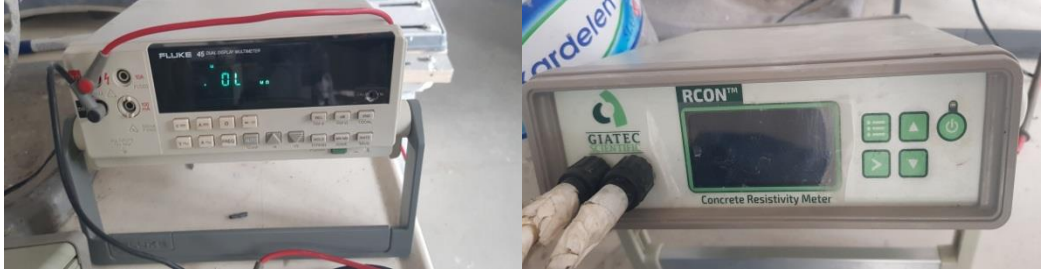
Şekil 3.12 Fluke Marka ve Rcon Marka özdirenç ölçerler
