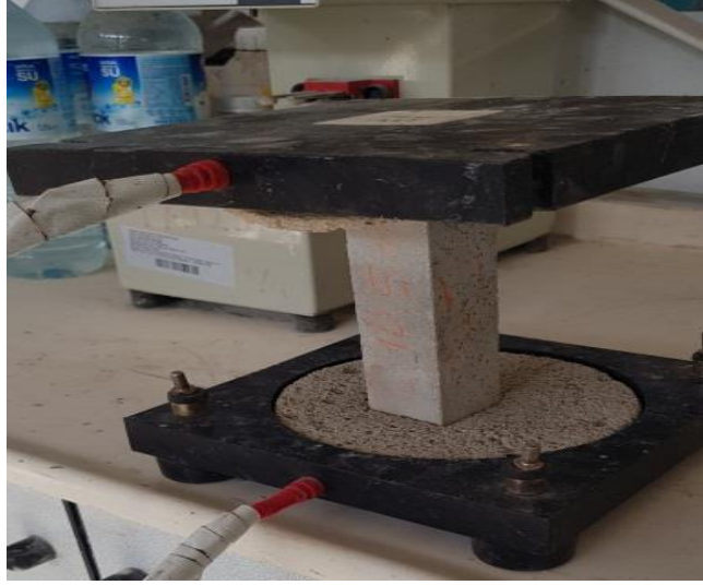
Şekil 3.13 Özdirenç ölçümü yapılan numune örneği
