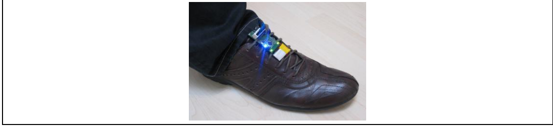
Fotoğraf 2.1. Mikrodenetleyici kartın yerleşimi [24]
