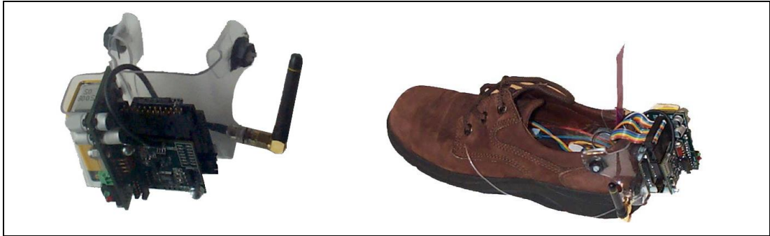
Şekil 2.11. Elektronik düzenek ve sensörlerin montaj şekli [25]
