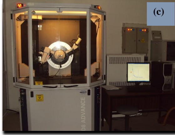
Fotoğraf 7.7. Görüntüleme ve faz analizi tespitinde kullanılan cihazlar: (a) Optik mikroskop, (b) SEM ve (c) XRD
