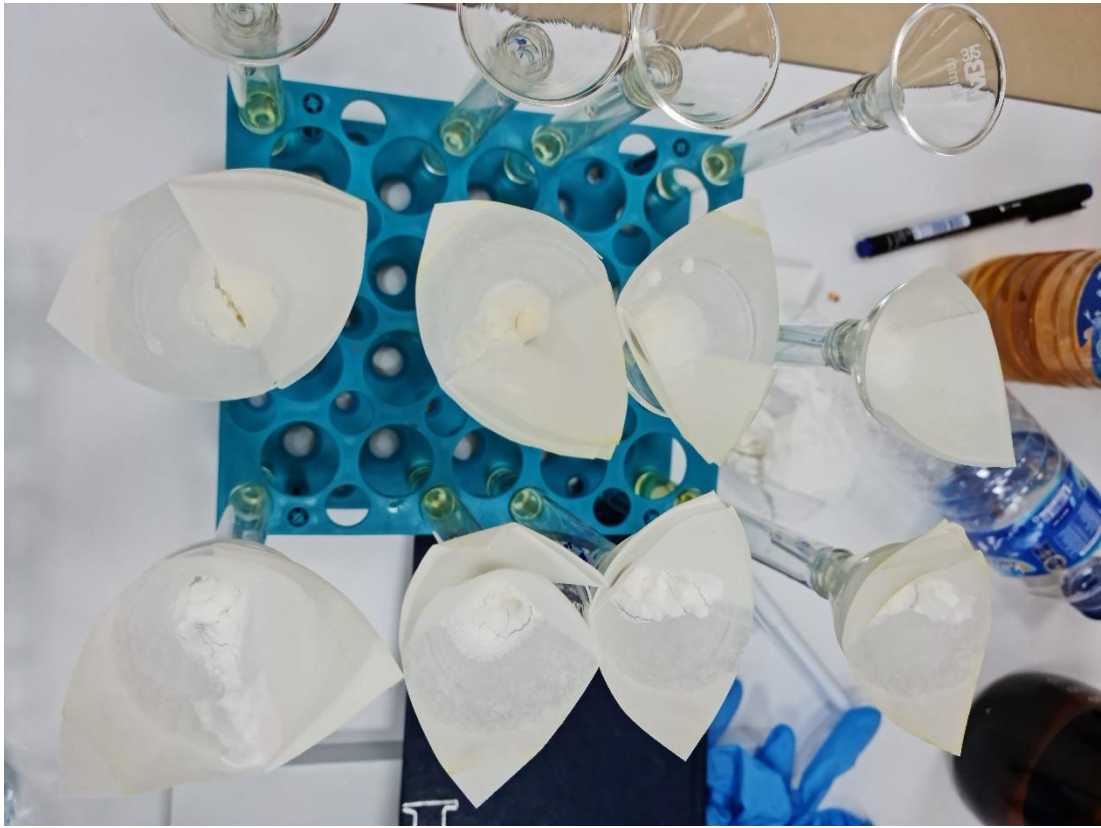
Şekil 3.4 Numunenin kağıt süzgeçten cam tüplere süzölmesi
