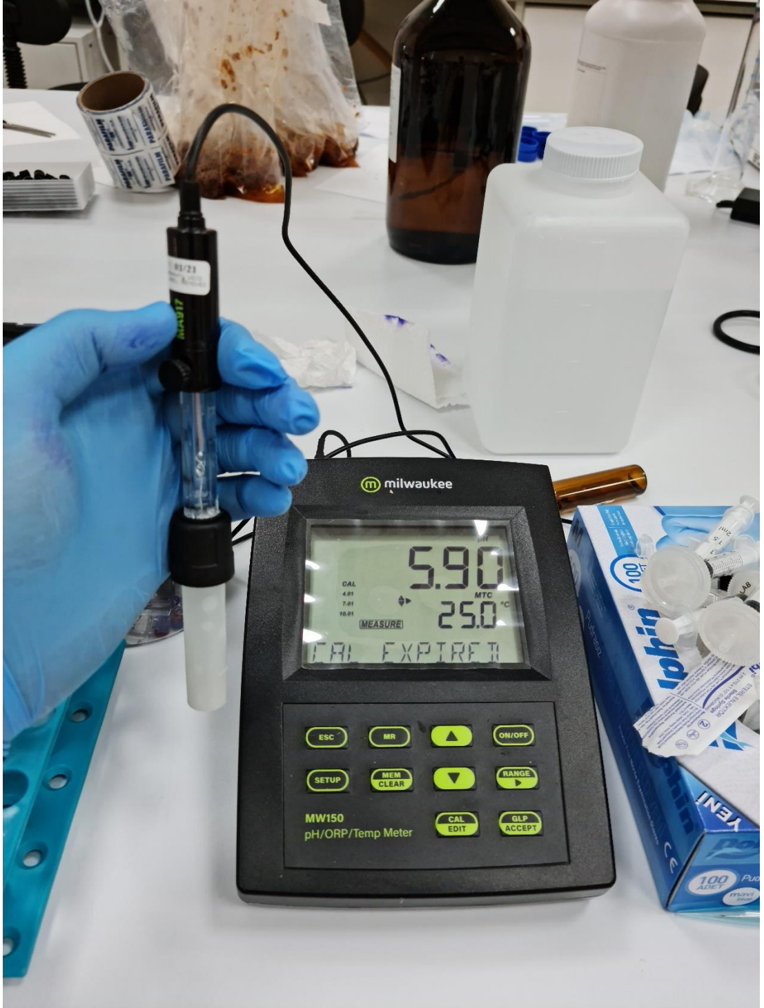
Şekil 3.1 pH ölçümlerinin yapıldığı milwaukee marka pH ölçüm cihazı
