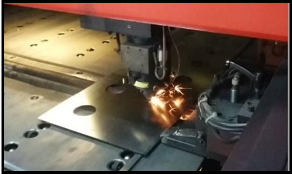
Şekil 4.1. HSLA çeliğinin lazer ile kesilmesi
