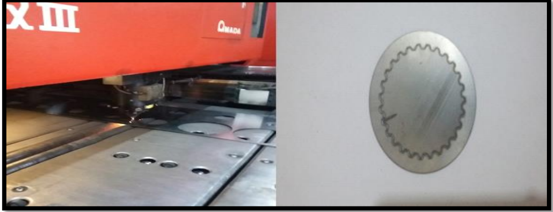
Şekil 3.3. HSLA Çeliğinde CO 2 Lazer ile Oyuk Yapılması
