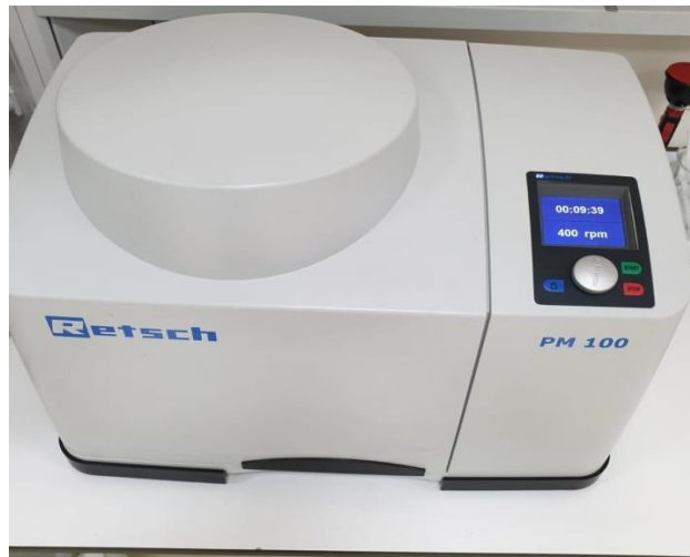
Şekil 5.3 Karıştırma işleminde kullanılan bilyeli karıştırıcı
