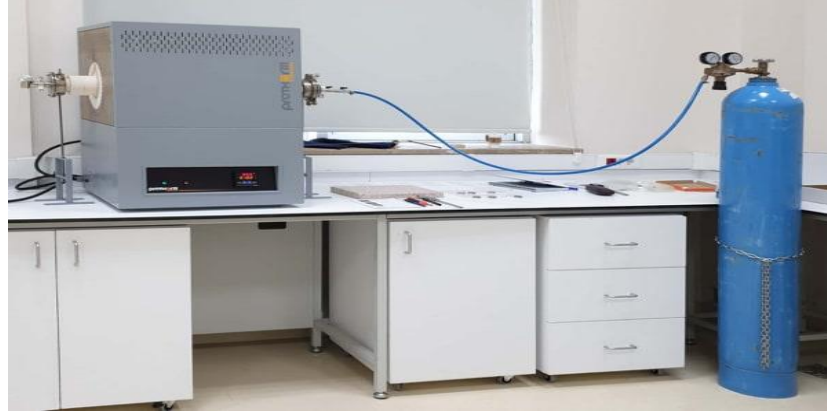
Şekil 5.6 Sinterleme işleminde kullanılan fırın
