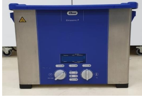
Şekil 5.2 Karıştırma işleminde kullanılan ultrasonik banyo
