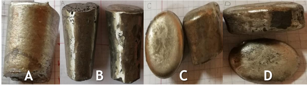
Şekil 3.2. Üretilen döküm numuneleri; (A) Fe-2,5Si-2,5B-0,05P-0,2C, (B) 42Fe-50Ni-6Si-2B, (C) 50Fe-42Ni-6Si-2B, (D) 46Fe-46Ni-6Si-2B
