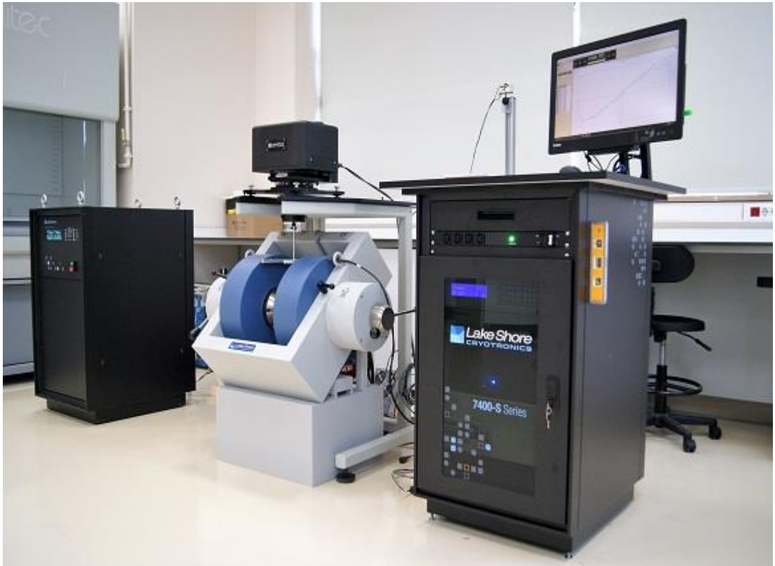
Şekil 2.5. Titreşimli Numune Manyetometresi (VSM) (Lake Shore - 7407) (Kastamonu Üniversitesi Merkezi Araştırma Laboratuvarı)
