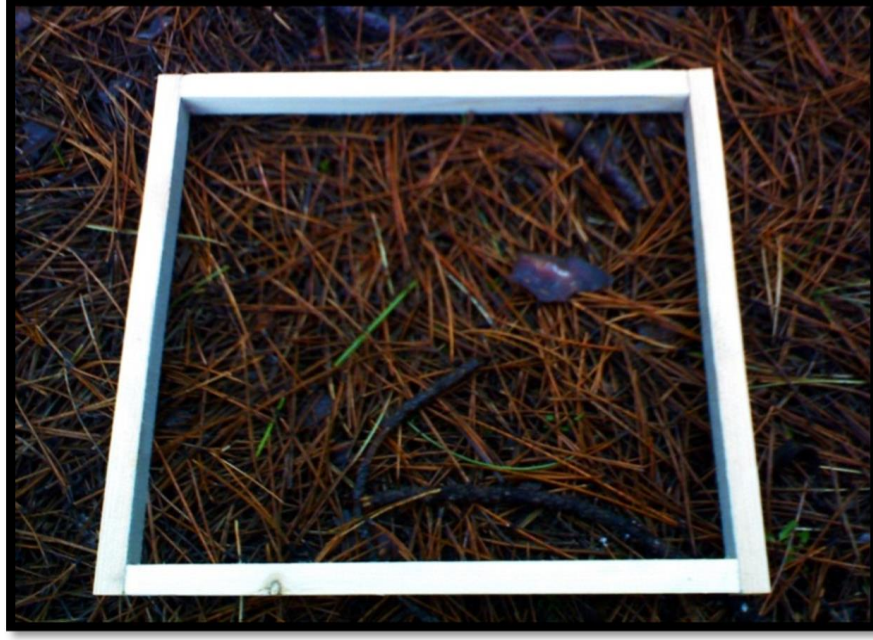
Fotoğraf 3.4 Ölü yanıcı madde örnekleri ve humus tabakasından alınan örneklerin deneme alanı 30 cm × 30 cm
