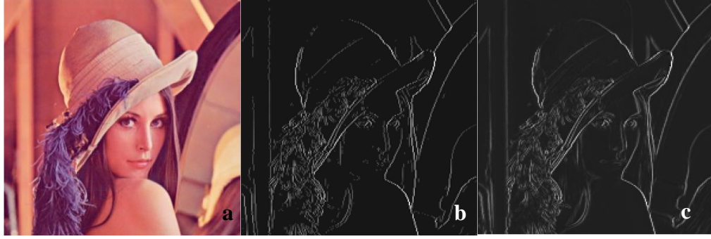
Şekil 4.13 a) Lenna orijinal görüntüsü, b) Sobel kenar algılama, c) Kenar algılama yöntemi birleşik YSA
