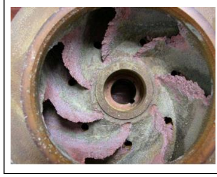
Şekil 1.5 Erozyon korozyonu (Alajaili, 2016)
