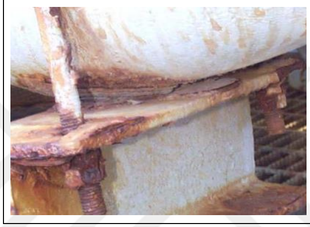
Şekil 1.1.4 Çatlak korozyonu (Britton vd., 2013)
