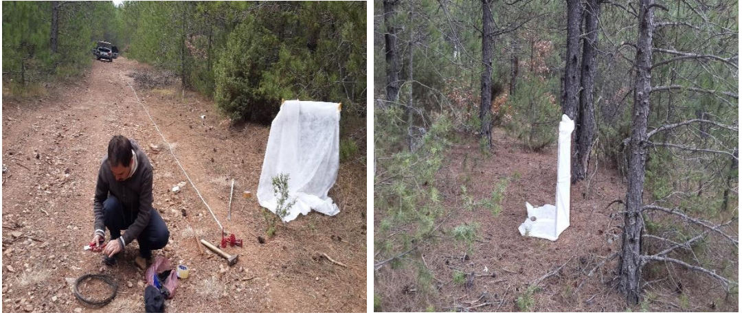
Fotoğraf 3.2. Sediment tuzaklarının hazırlanması, yol kenarlarına ve meşcere içersine kurulumu
