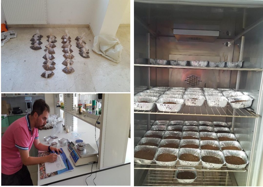
Fotoğraf 3.5. Toplanan sedimentlerin laboratuvarda tartılması, kurutulması ve örneklenmesi
