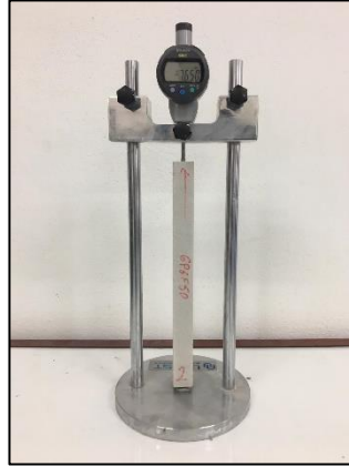
Şekil 3.7 Kuruma büzülmesinin komparatör ile ölçümü
