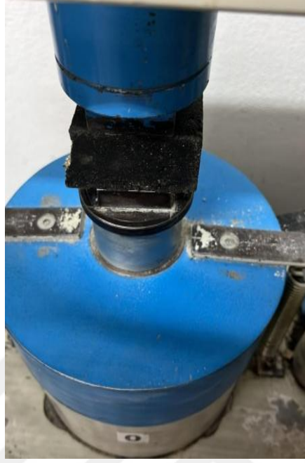
Şekil 3.6 Basınç dayanımı ölçülen numune
