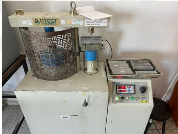
Şekil 3.7 Eğilme dayanım testine tabi tutulan numune örneği
