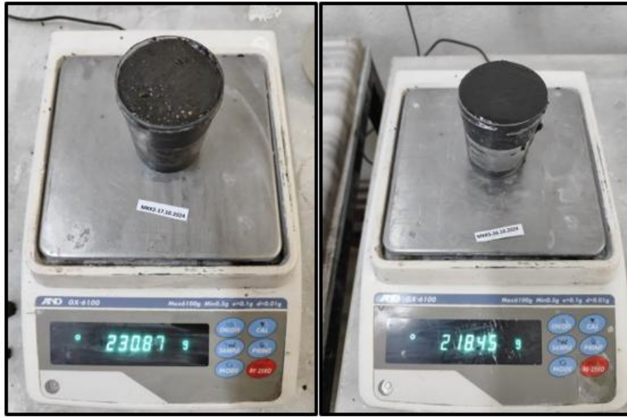
Şekil 4.1 Birim ağırlık ölçümü ve numune örneği
