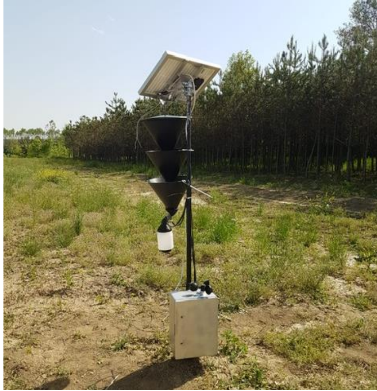
Fotoğraf 3.1 Elektronik denetleme birimli feromon tuzağı
