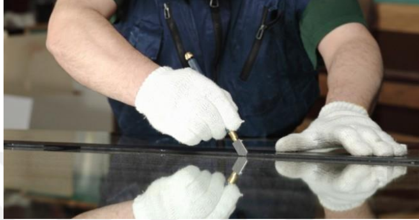
Görsel 3.22 Elmas ile Cam Kesimi
