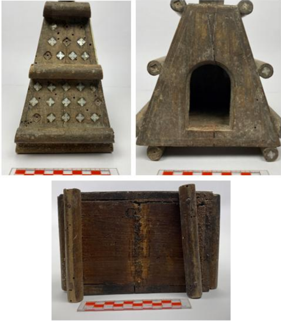
Resim 5.9 Eserin kenar parçalarının birleşim yerlerinde meydana gelen gevşeme ve ayrılmalar
