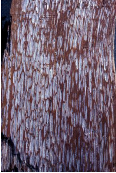
Resim 2.7 Beyaz çürüklük mantarları ile enfekte olmuş çam odunu (Blanchette, RA, Ahşapta çürümeye neden olan mikroorganizmalar, Orman Patolojisi Laboratuvarı, Minnesota Üniversitesi) (Care For Cultural Material-Wood, 2024)
