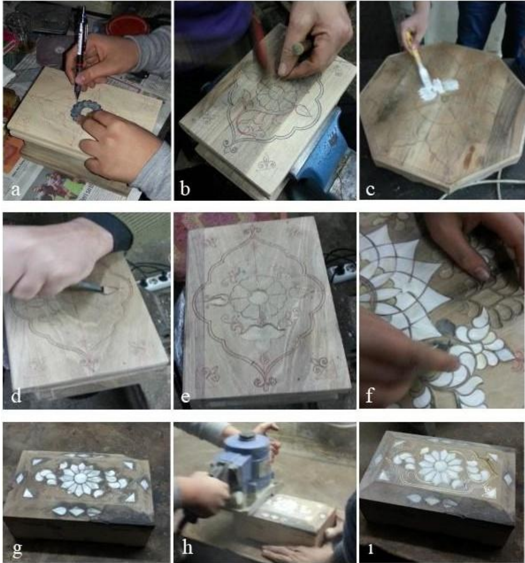
Resim 2.4 Sedef kakma yapım aşamaları; a- motif çizimi, b- kontür kenarlarına tel yerleştirme c- tellerin tutkalanması, d- sedef oyuğunun açılması, e- oyulmuş ürün, f- sedef oyuğunun macunlanması, g- macunlu ürün, h- zımparalama, ı- zımparalanmış ürün (Özdemir ve Yıldırım, 2016, s. 426-430)
