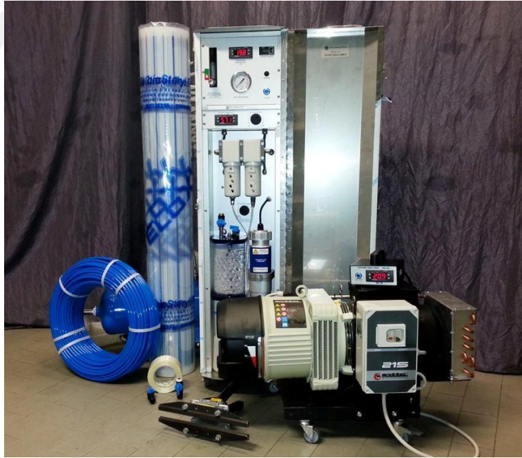
Resim 6.10 Veloxly 1000 azot jeneratör sistemi (Insitu Museum and Archive Services, 2024)
