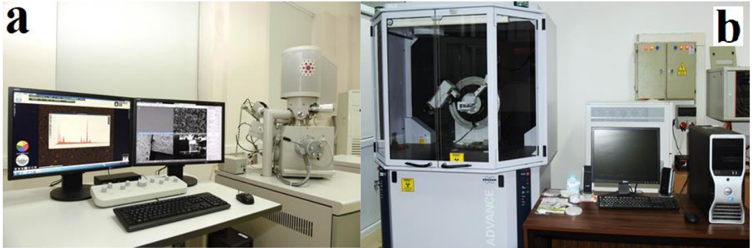
Fotoğraf 4.8 Görüntüleme ve faz analizi tespiti için kullanılan cihazlar: (a) SEM ve (b) XRD
