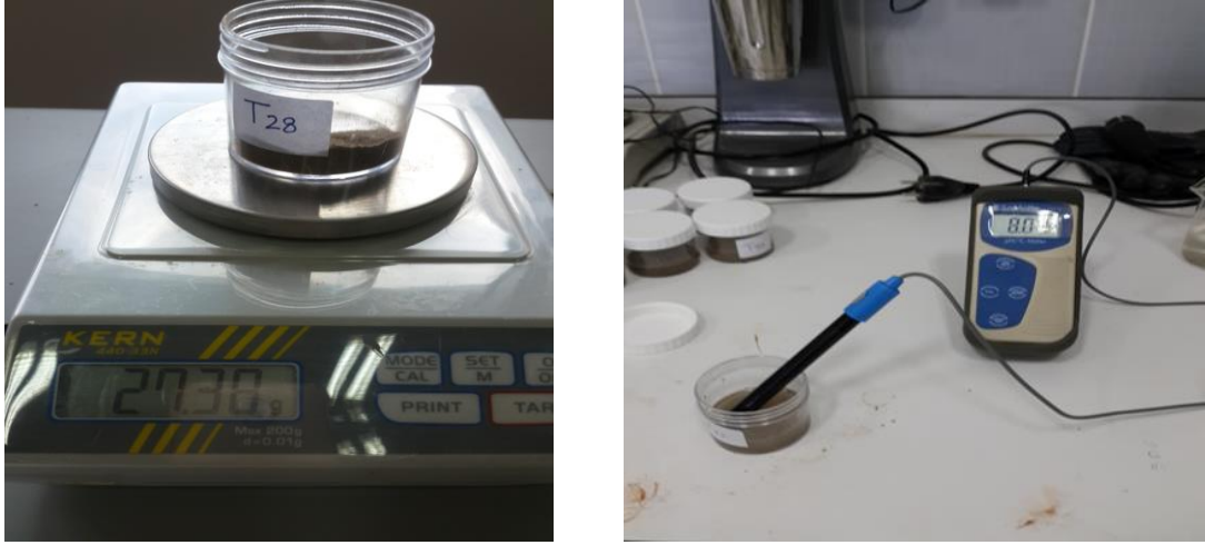
Fotoğraf 3.1. Zeolit pH ölçme işlemi (Garad, 2019)
