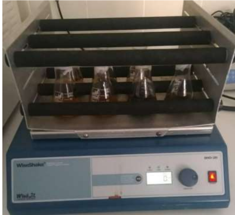
Şekil 4.2 Mantar ekstraktları, çalkalayıcı üzerinde oda sıcaklığında, 3 gün süreyle çözücü ile muamele edilerek hazırlanmıştır
