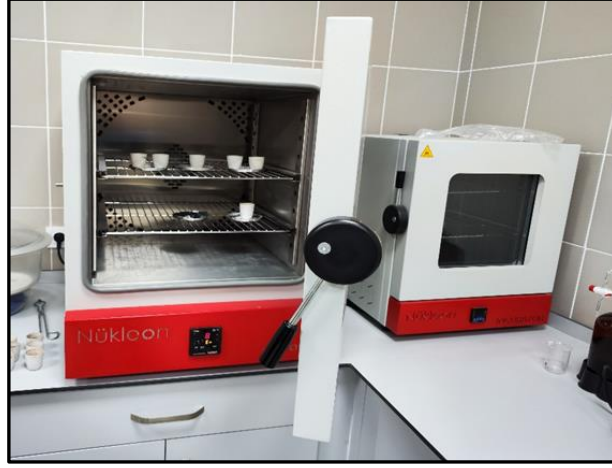
Şekil 3.10 Etüv ve kül fırını ile laboratuvar analizlerine dair çalışma (Yazar tarafından oluşturulmuştur, 2023)
