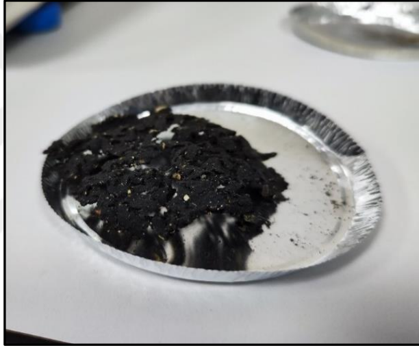
Şekil 3.11 Kurutulmuş solar çamura ait numune (Yazar tarafından oluşturulmuştur, 2023)
