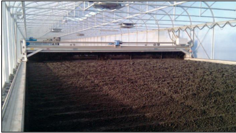
Şekil 2.2 Solar kurutma sisteminde serilmiş çamur (Ekinci, 2019)
