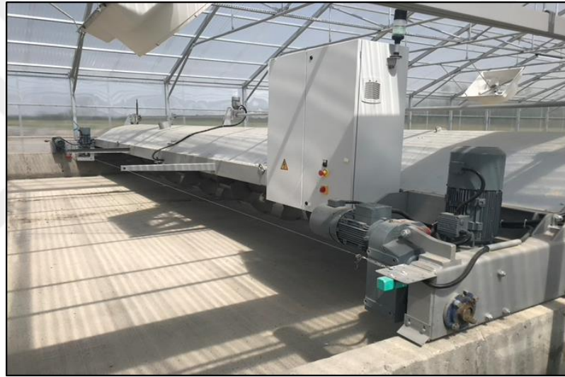
Şekil 3.7 Solar amur kurutma ünitesinde bulunan amur karıştırma makinesi (Yazar tarafından oluşturulmuştur, 2022)
