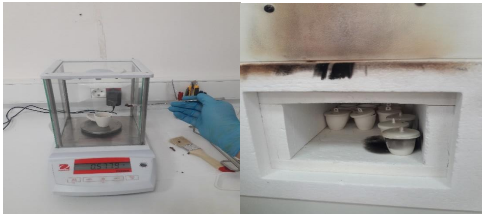
Şekil 3.6 Kül analizi örnek tartımları ve kül fırını
