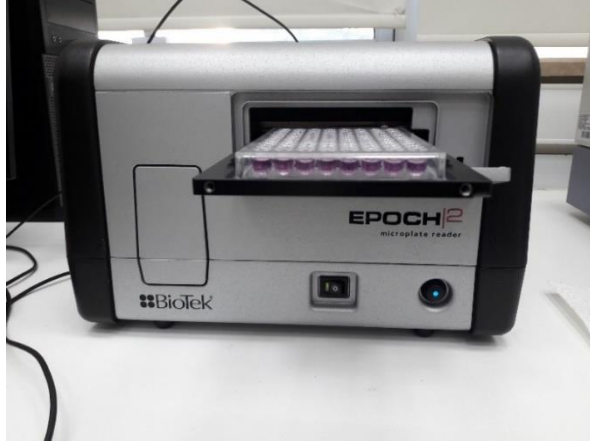
Şekil 3.10 Örneklerin okutulduğu UV-VIS spektrofotometre
