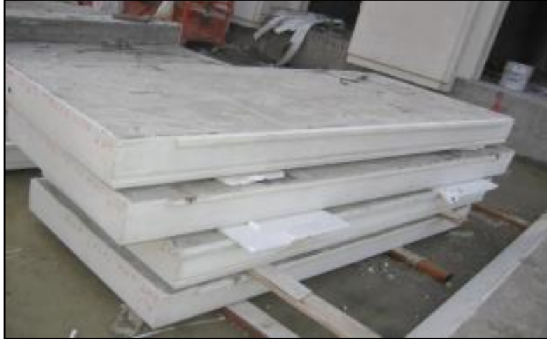
Şekil 3.2 Yalıtım katmanında köpük beton kullanılan panel örneği (Altınay, 2011)
