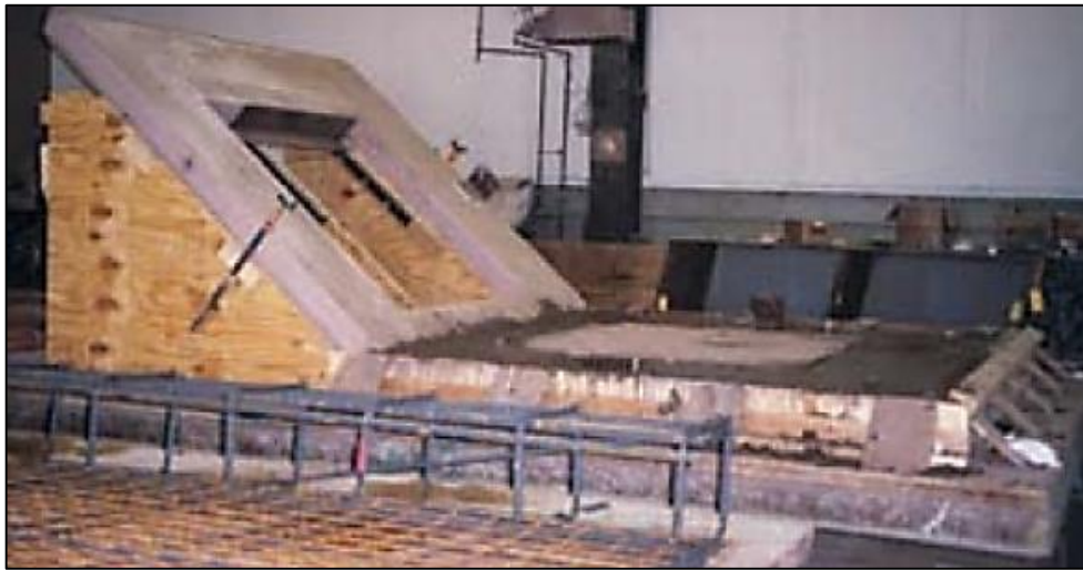
Şekil 2.8 Üretim aşamasında beton esaslı prekast ağır cephe paneli örneği (PCI, 2007)
