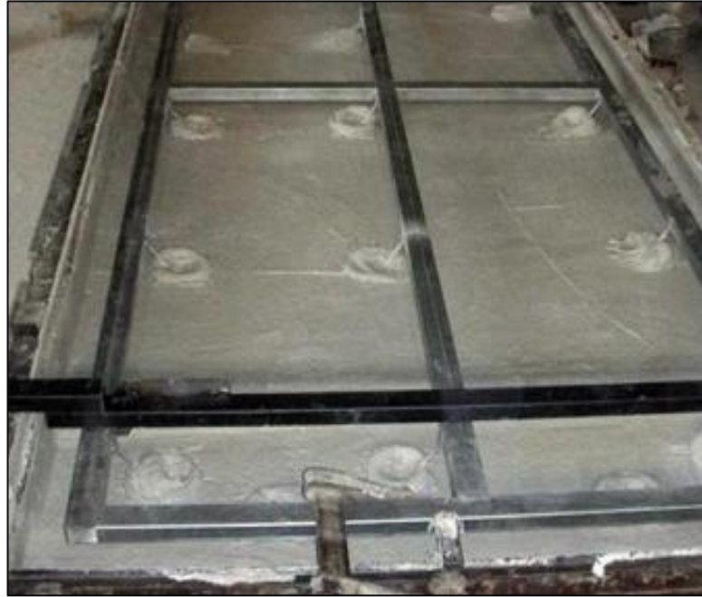
Şekil 3.15 GFRC kabuğa monte edilmiş çelik çerçeve ve bağlantı çubukları
