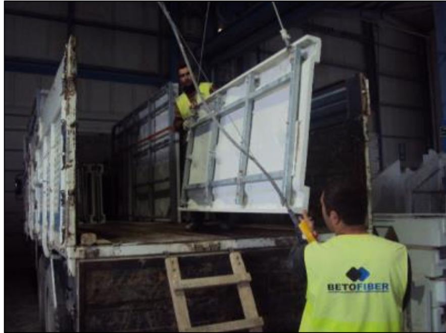
Şekil 3.25 GFRC elemanların nakliye aracına yüklenmesi (Özgün, 2017)
