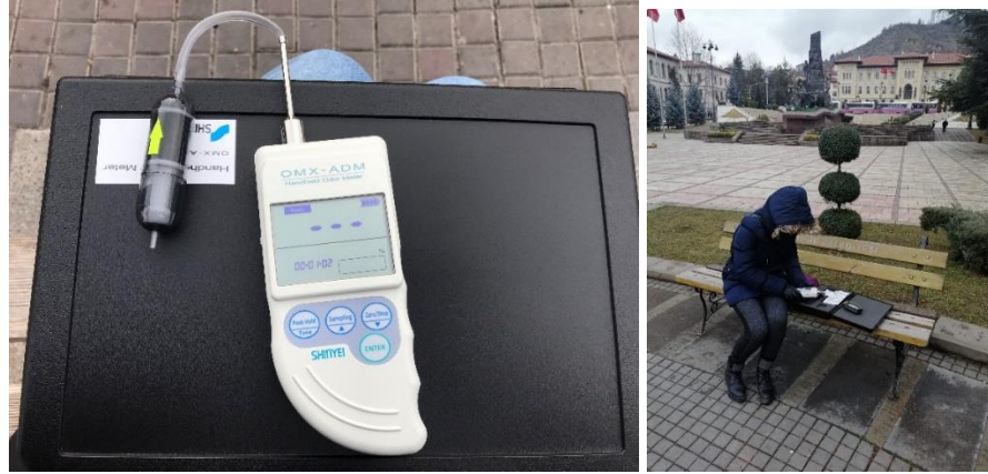
Şekil 4.7 Koku ölçüm cihazı ve ölçüm görüntüleri (Orijinal, 2020)
