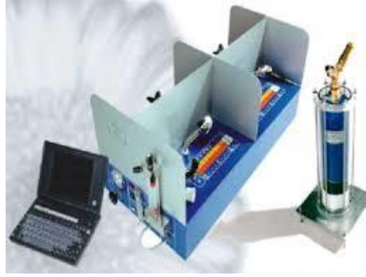
Şekil 2.10 Olfaktometre cihazı (URL-5, 2020)
