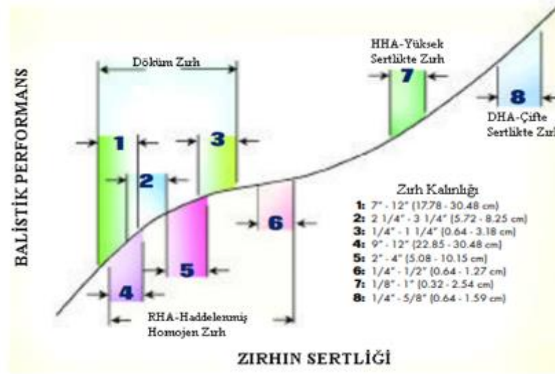
Şekil 4.8 Zırh çeliklerinin balistik performansı (Lane vd., 2002)
