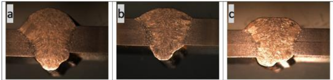
Şekil 8.6 MG 183 kodlu tel ile yapılan kaynaklı birleştirmeye ait makroyapı görüntüleri a) N16 numaralı deney, b) N17 numaralı deney, c) N18 numaralı deney
