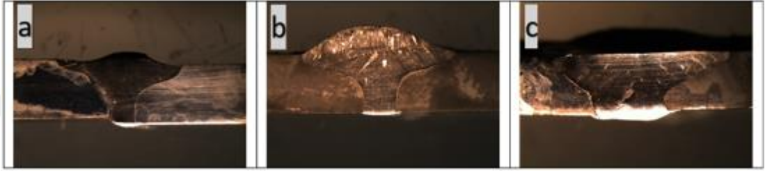
Şekil 8.3 EI 312/E 106 kodlu örtülü elektrodla (Ø2,5 mm) yapılan kaynaklı birleştirmeye ait makroyapı görüntüleri a) N7 numaralı deney, b) N8 numaralı deney, c) N9 numaralı deney
