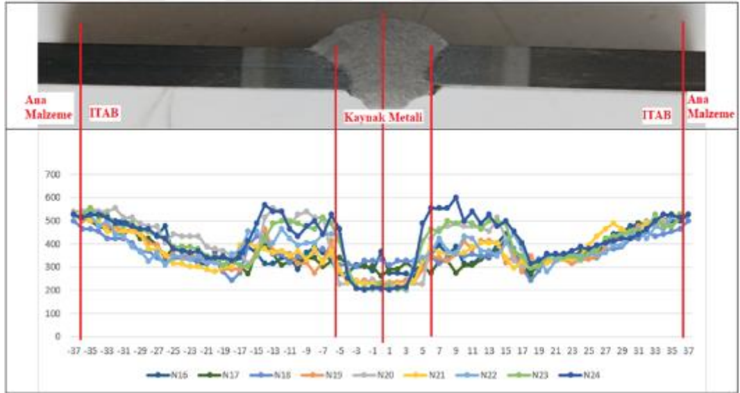
Şekil 8.102 1 mm ilave tellere ile yapılan birleştirmeye ait mikrosertlik grafiği
