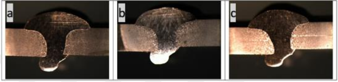
Şekil 8.8 MI 307Si kodlu tel ile yapılan kaynaklı birleştirmeye ait makroyapı görüntüleri a) N22 numaralı deney, b) N23 numaralı deney, c) N24 numaralı deney
