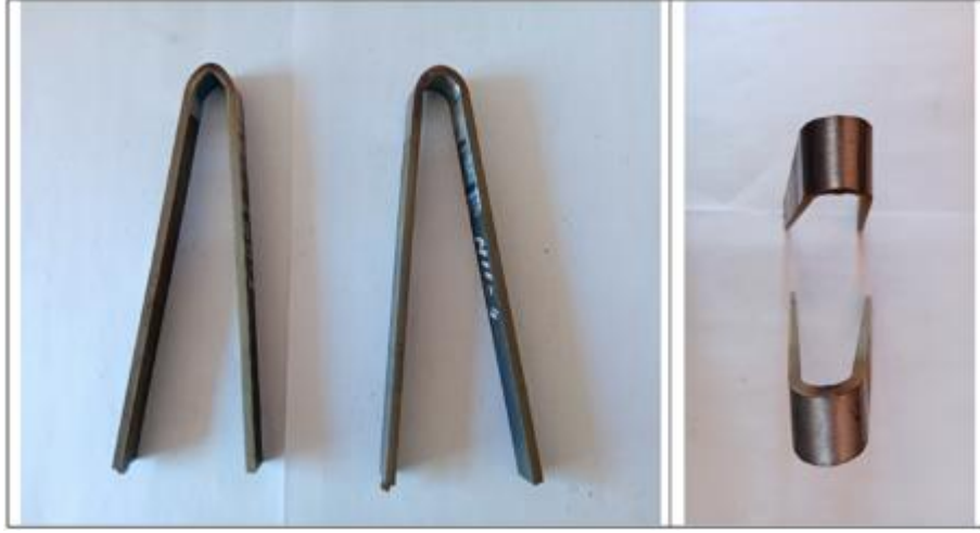
Şekil 8.107 N11 deneyine ait eğme testi gerçekleştirilmiş numuneler
