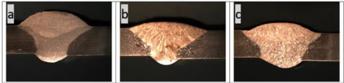
Şekil 8.2 TENACITO 80 kodlu örtülü elektrodla (Ø3,25 mm) yapılan kaynaklı birleştirmeye ait makroyapı görüntüleri a) N4 numaralı deney, b) N5 numaralı deney, c) N6 numaralı deney
