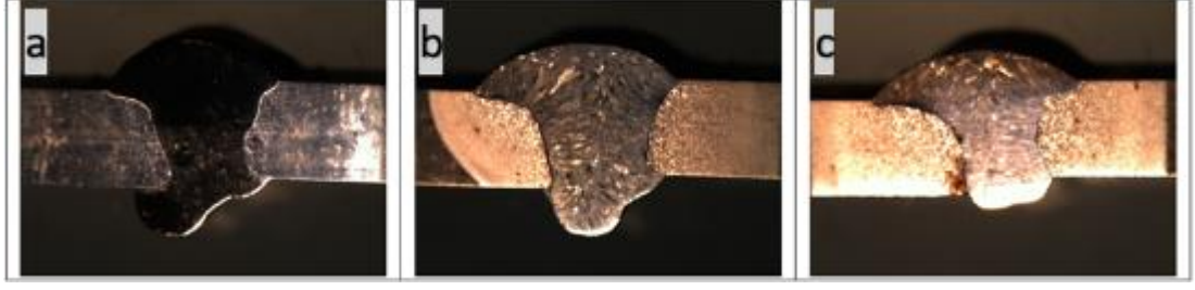
Şekil 8.7 MI 312 kodlu tel ile yapılan kaynaklı birleştirmeye ait makroyapı görüntüleri a) N19 numaralı deney, b) N20 numaralı deney, c) N21 numaralı deney
