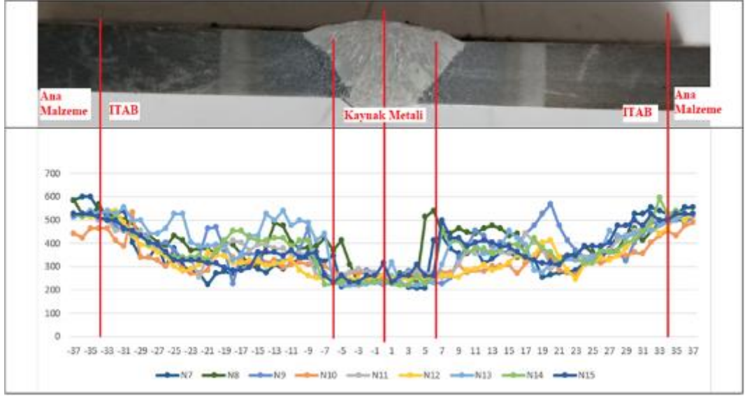
Şekil 8.101 2,5 mm elektrodla ile yapılan birleştirmeye ait mikrosertlik grafiği
