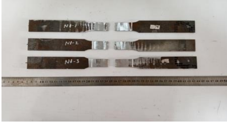
Şekil 8.88 N1 numaralı birleştirme numunelerinin çekme testi sonrası görüntüsü
