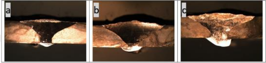
Şekil 8.1 CITOCHROMAX kodlu örtülü elektrodla (Ø3,25 mm) yapılan kaynaklı birleştirmeye ait makroyapı görüntüleri a) N1 numaralı deney, b) N2 numaralı deney, c) N3 numaralı deney
