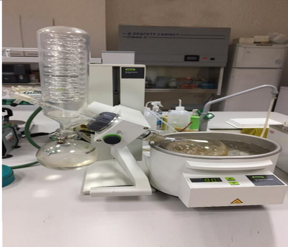
Şekil 3.1. Evaporatör vasıtası ile özüt çıkarma işlemi
