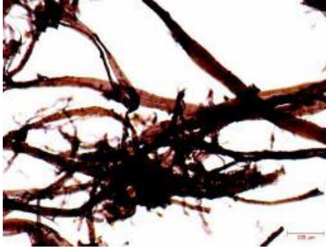
Görsel 3.40 Herzberg çözelti damlatılmış lif numunesi mikroskop görüntüsü, 200x
