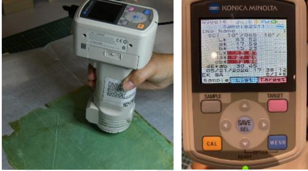
Görsel 3.44 Sayfaların kolorimetre ile renk ölçümünün yapılması ve değerleri
