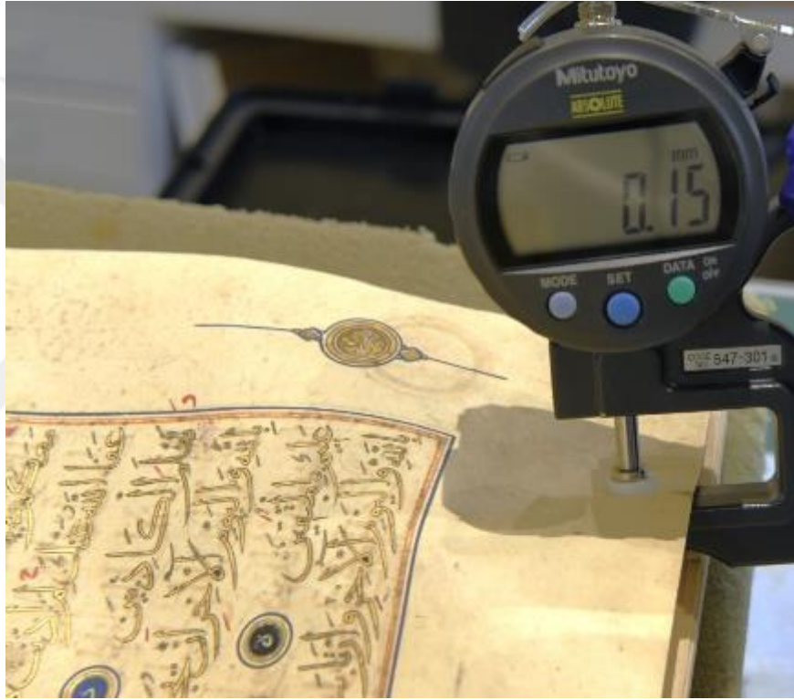
Görsel 3.15 Sayfa kalınlığının mikrometre ile ölçümü
