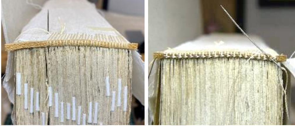
Görsel 3.63 Kolon ve şiraze yapım aşaması
