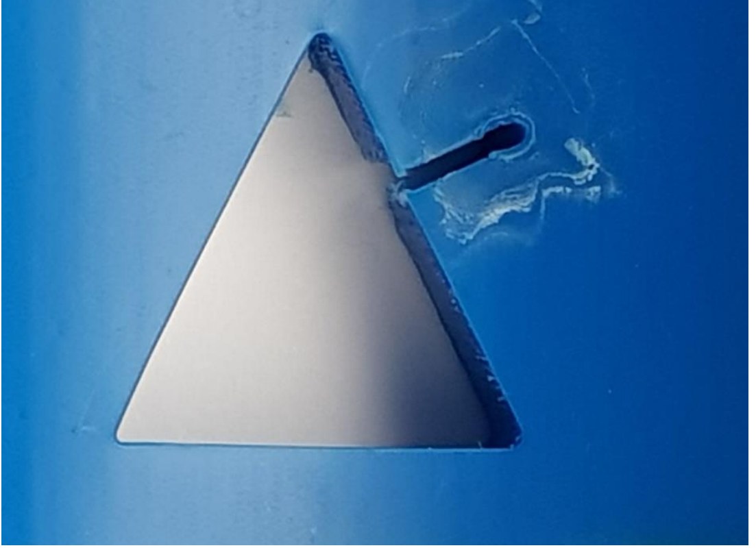
Şekil 3.13. Havayla kesilen üçgen örneğinin iç kısmı
