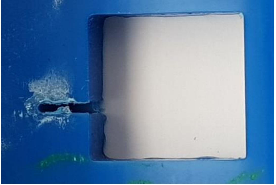
Şekil 3.25. Oksijenle kesilen kare örneğinin iç kısmı
