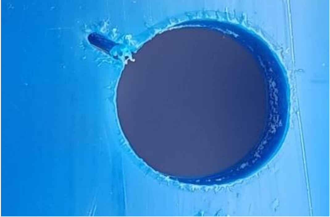
Şekil 3.12. Havayla kesilen daire örneğinin dış kısmı
