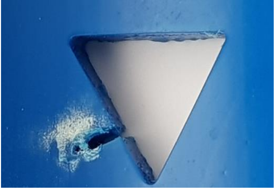
Şekil 3.27. Oksijenle kesilen üçgen örneğinin iç kısmı
