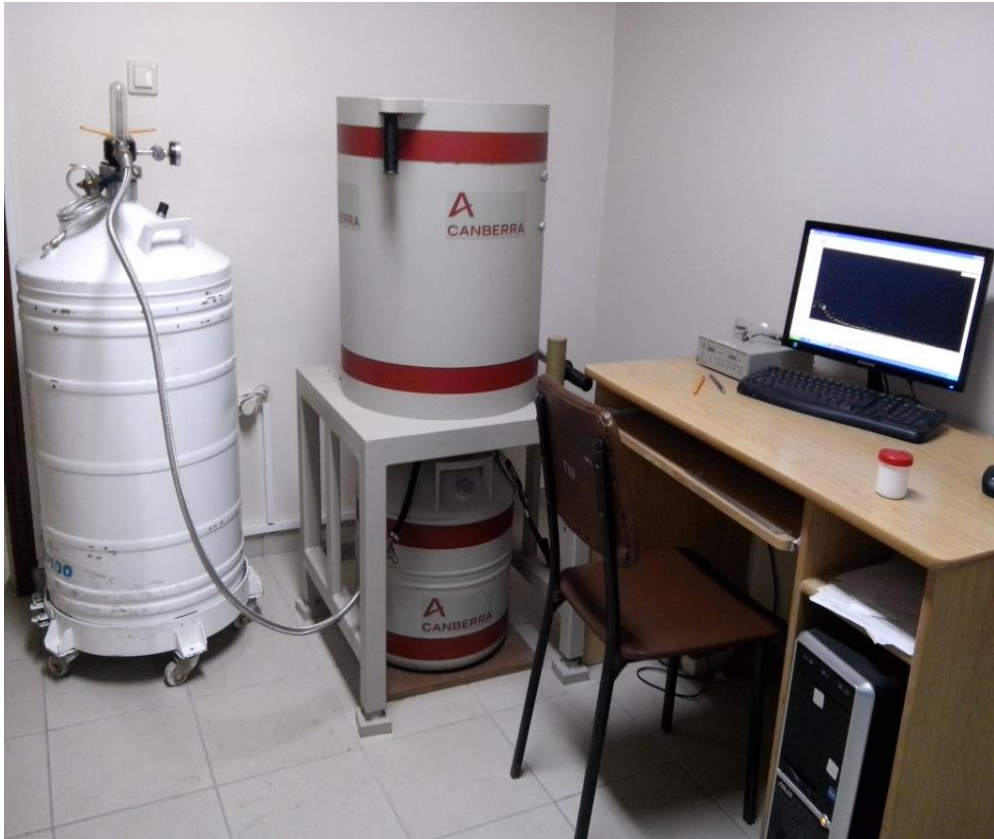
Fotoğraf 3.2. HPGe dedektörlü gama-ışını spektrometresi
