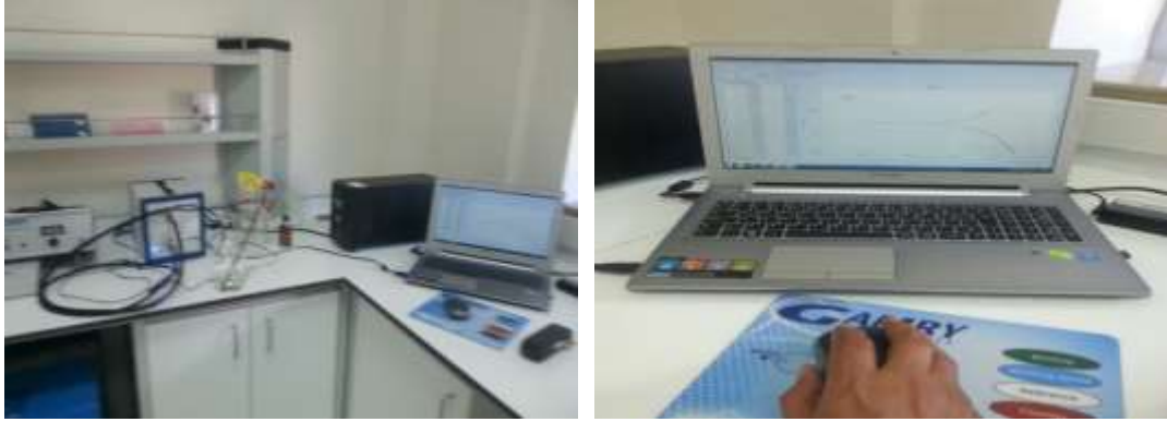
Şekil 3.9. Korozyon Deneylerinin Yapıldığı Düzenek
