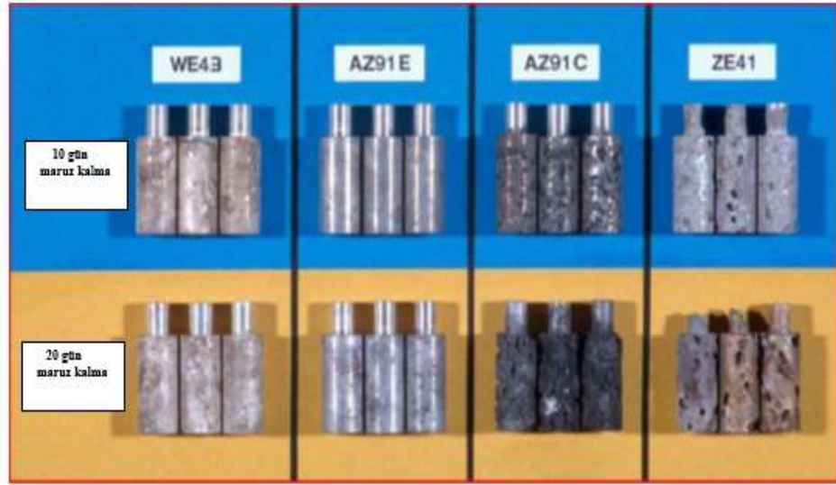
Şekil 2.10. ASTMB117 tuz sis testi sonrası galvanik korozyon test silindiri (Muñoz, 2012).
