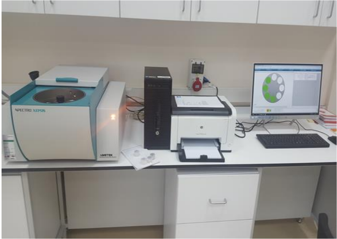
Fotoğraf 3.3. Analiz işlemleri için kullanılan EDXRF spektrometresi
