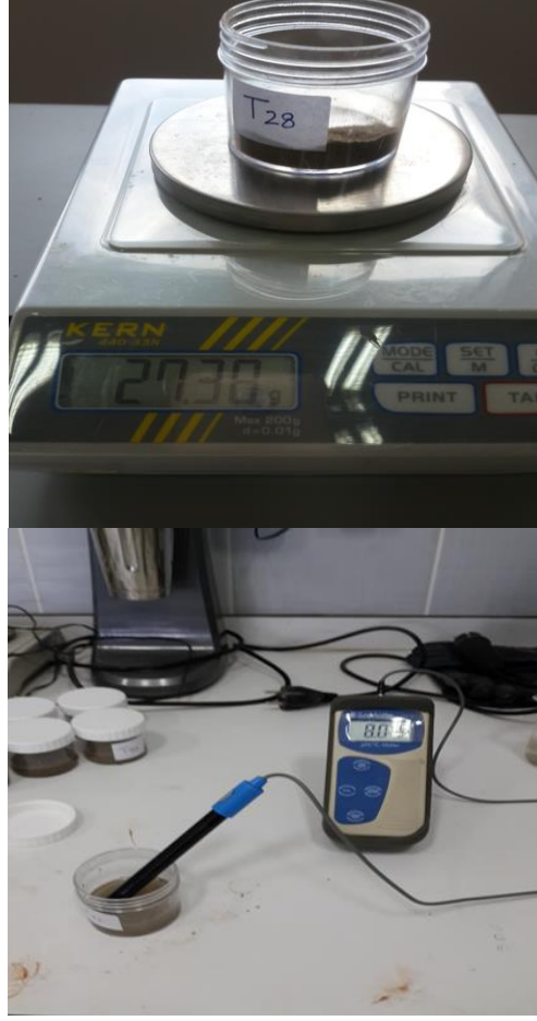
Fotoğraf 3.2. pH ölçme işlemi
