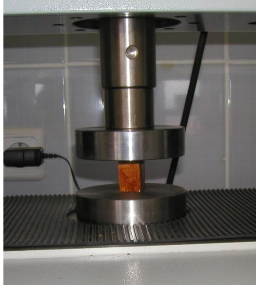
Fotoğraf 3.4. Liflere paralel basınç direnci deneyi
