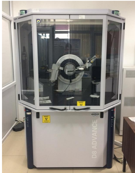
Fotoğraf 3.1. X-ışınları difraktometresi (XRD)
