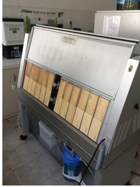
Fotoğraf 3.5. Hızlandırılmış (UV) yaşlandırma cihazı
