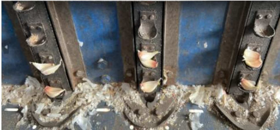
Şekil 3.12 Sarımsak dişlerinin kaşıkçıklardaki durumlarına örnekler
