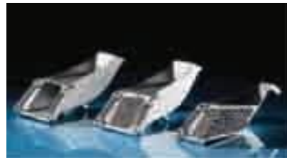
Resim 2.3. LKR ve BMW tarafından geliştirilmiş motor blok örneği, soldan sağa; bos döküm, alüminyum köpük çekirdek içeren yekpare parça, kesit görüntü [21]
