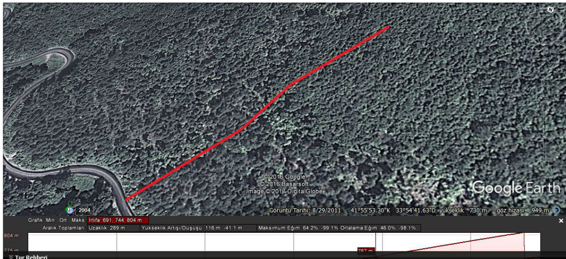
Şekil 4.3. Google Earth Yardımıyla Bulunan Ortalama Eğim ve Mesafe Örneği
