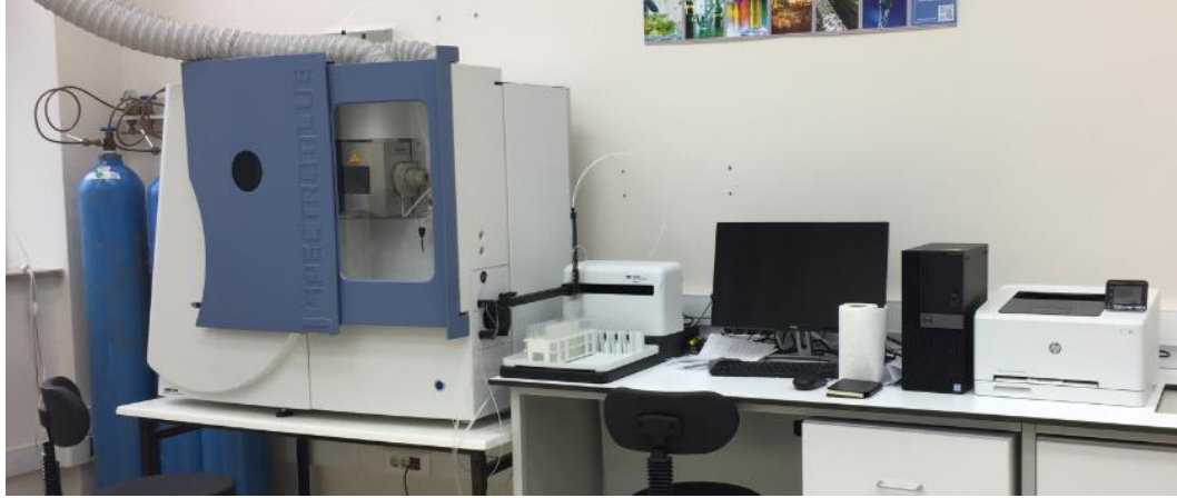
Fotoğraf 3.2. Ağır metal analizlerinin yapıldığı ICP-OES cihazı
