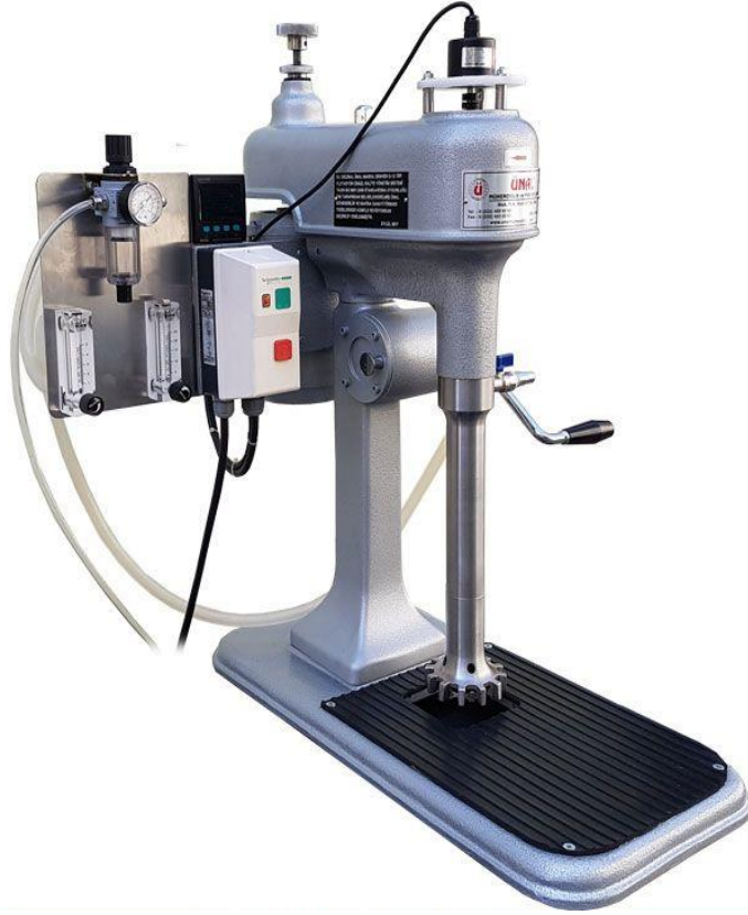
Fotoğraf 4.1. Denver D-12 flotasyon cihazı
