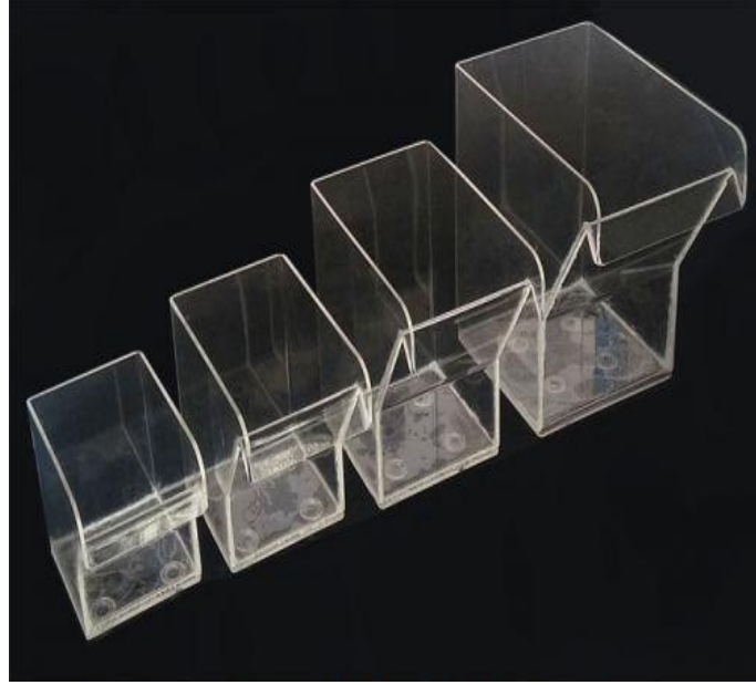
Fotoğraf 4.2. Denver D-12 flotasyon selülleri
