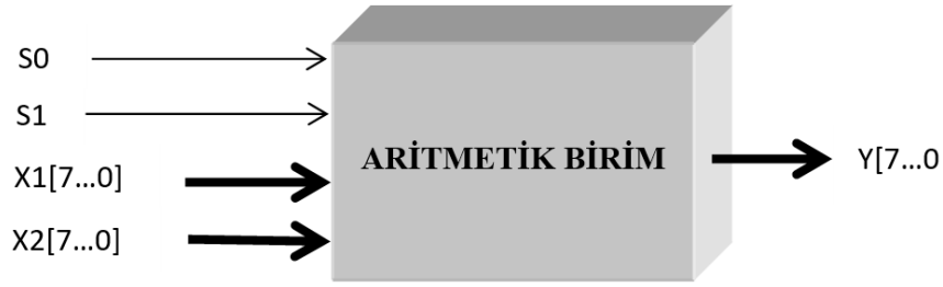
Şekil 3.23. Bir aritmetik birimin yapısı.
