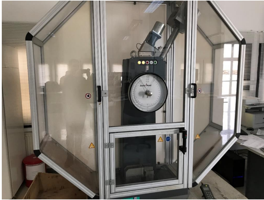
Şekil 3.7. Zwick 450 Darbe Testi Cihazı
