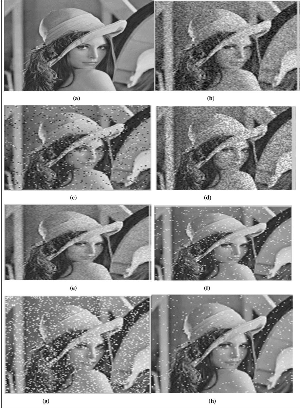
Şekil 2.3. Gürültü çeşitleri örnekleri. (a) Orijinal görüntü. (b) Gauss gürültüsü eklenmiş görüntü, (c) Darbe gürültüsü eklenmiş görüntü, (d) Benek gürültüsü eklenmiş görüntü, (e) Poisson gürültü eklenmiş görüntü, (f) Tekdüze gürültü eklenmiş görüntü, (g) Rayleigh gürültü eklenmiş görüntü, (h) Gama gürültü eklenmiş görüntü
