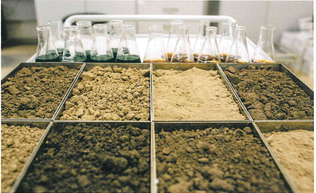
Şekil 2.9. Araziden alınan toprak örneklerinin laboratuvarda kurutulması
