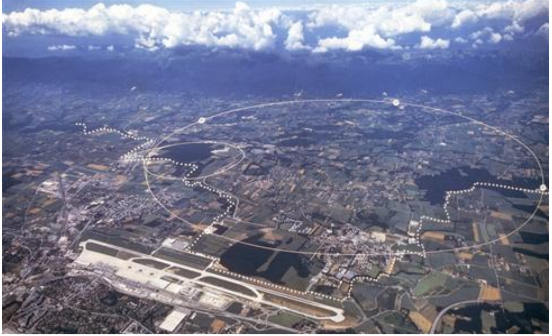
Resim 3.1. CERN’de bulunan LHC halkası [19]
